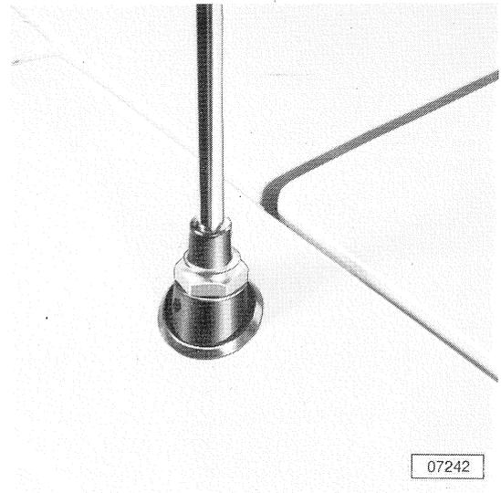
Antennenkabel aus Seitenwand herausziehen.
