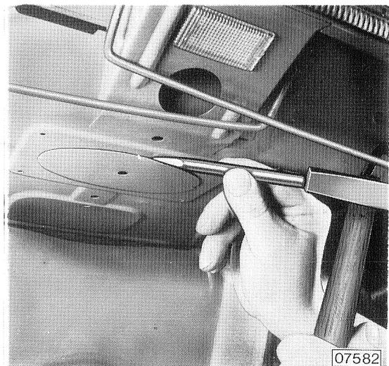
Bezug von Rücksitz und Hinterrücken aushängen. Hierzu ist die Bezugverstärkung aus den Haken bzw. der Halteschiene herauszuheben.
