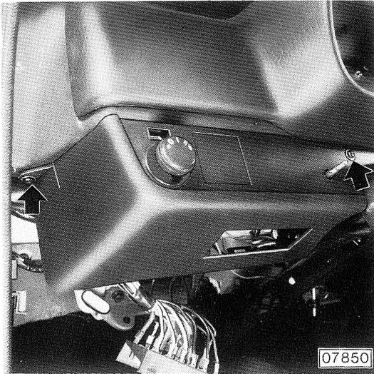
Mehrfachstecker von der Rückseite des Lichtschalters abziehen.
