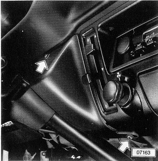
Rechte Lenkstützzrohrverkleidung ausbauen. Hierzu eine Blechgewindeschraube an der Instrumententafel - Unterseite und eine Blechgewindeschraube an der Stirnseite der Verkleidung abschrauben.
