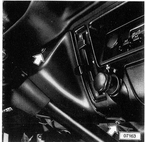
und 5 Schrauben am Schaltergehäuse entfernen.
