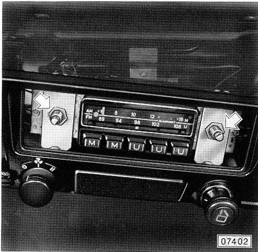
Auf vordere Radiobefestigung Unterlegscheiben aufstecken. Je nach Radio-Typ Skala und Zierblende montieren.
