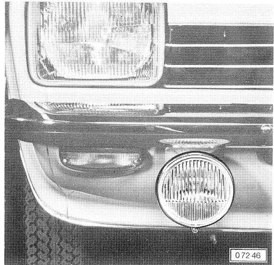
Am unteren Luftleitblech links und rechts Löcher für die Befestigung der Nebelscheinwerfer anreißen, Löcher 8,5 mm  $\varnothing$  und 13,5 mm  $\varnothing$  bohren.
